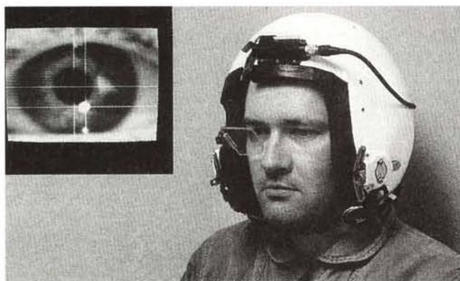
Ecco gli elementi fondamentali che costituiscono EVIL EYE. Nella foto in basso vediamo inoltre, al fianco del computer, la centralina di controllo di un sensore posizionale Polhemus utilizzato nell'head tracking per rilevare la posizione della testa dell'operatore insieme a quella dello sguardo. A sinistra, un particolare dell'EYE Imaging System.
